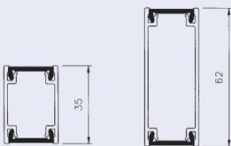
Kaliprofielen / Profils de traverse (20, 24 of/ou 28 mm)
